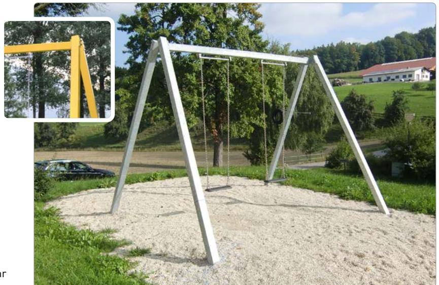
Beschreibung: Schaukelstützen aus Stahl-Formrohr 100/100/4 mm, verzinkt, mit angeschweißten Flanschplatten zur Montage der Schaukel-Lager, Schaukelbalken aus Stahl-Formrohr 100/100/4 mm, 3,0 m, Pendel-Kugellager mit Achse, mit trapezförmigen Flanschen zur Verschraubung an den Schaukelstützen, 2 Abhängungen, 2 Sicherheitsschaukeln standard.
