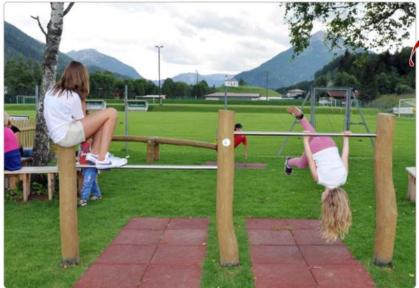
**Beschreibung:** 2, 3 oder 4 Rundsteher, Mindest  $\varnothing$  15 cm, Reckstangen aus Edelstahlrohr  $\varnothing$  35 mm, Reckstangen einseitig mit einer Platte verschweißt, die Platte wird an den Stehern als Verdrehungssicherung verschraubt, Schrauben Edelstahl.
