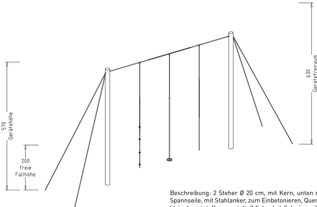
Beschreibung: 2 Steher  $\varnothing$  20 cm, mit Kern, unten mit je 1 Pendelstützenlager, je 2 Spannseile, mit Stahlanker, zum Einbetonieren, Querseil in Herkules-Machart, mehrlitig, kunststoffummantelt, 3 Schaukel-Schwingseilgelenke, bestückt mit 1 Knoten-
