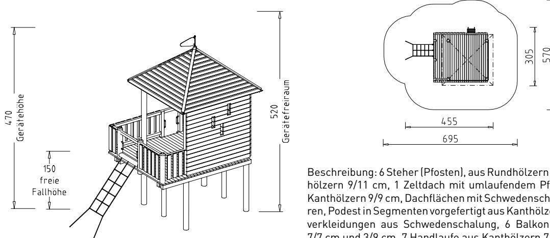
**Beschreibung:** 6 Steher (Pfosten), aus Rundhölzern Ø 12 cm, 6 Unterzüge aus Kanthölzern 9/11 cm, 1 Zeltdach mit umlaufendem Pfettenrahmen und Sparren aus Kanthölzern 9/9 cm, Dachflächen mit Schwedenschalung vorgefertigt, 4 Decksparren, Podest in Segmenten vorgefertigt aus Kanthölzern 3,5/10 cm, genutet, 2 Wandverkleidungen aus Schwedenschalung, 6 Balkon-Brüstungen aus Kanthölzern 7/7 cm und 3/9 cm, 7 Handläufe aus Kanthölzern 7/7 cm, 1 Strickleiter, 1 Netzeinstieg ohne Rahmen.
