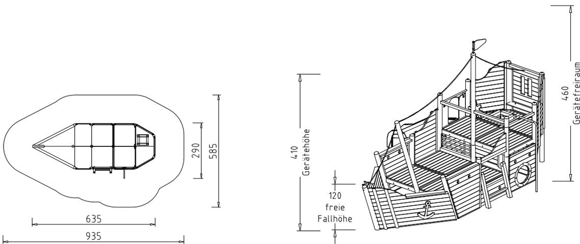
**Beschreibung:** 14 Steher (Pfosten) und 1 Poller aus Rundhölzern Ø 12 cm, Schiffsdeck aus 6 Viereckpodesten, 1/2 Sechseckpodest, MAXIMO-System, 4 Handläufe aus Kanthölzern 7/7 cm, 13 Schiffs-Außenwände, beplankt mit Kanthölzern 3/12 cm, mit Abdeckleisten, teilweise mit Bullaugen und Schlupflöchern, 1 Feuerwehr-Kletterstange, 1 Aufstiegsleiter schräg, 1 Steuerrad, drehbar, 1 Sitzbank, 1 Reifentrichter, Applikationen (Anker, Bullaugen) aus Dreischicht- bzw. Siebdruckplatte, 1 Wimpel.
