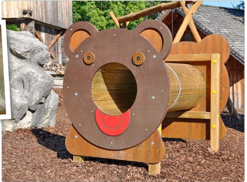
Beschreibung: 2 Rahmen aus Kanthölzern 9/9 cm, mit Schichtholzplatte beplankt, 1 Kriechtunnel aus einzelnen trapezförmigen Latten zusammengesetzt, 1 Spannreifen, Stahl verzinkt, 2 Verkleidungsplatten aus HPL mit Bärenmotiv.
