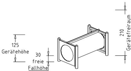
Beschreibung: Kriechrohr aus glasfaserverstärktem UP-Rohr, Farbe gelb, in 200 cm od. 300 cm lieferbar, Rahmenkonstruktion aus Kanthölzern 9/9 cm, 2 Stirnplatten mit kreisrundem Ausschnitt, aus Schichtholzplatten, 1 Längsstrebe aus Kantholz mit Dach-Anschnitt zum Schutz des Rohres.
