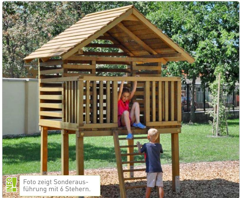
Beschreibung: 4 Kantsteher (-pfosten) 9/9 cm, Podest mit Unterzügen aus Kantholz 9/9 cm und Belag aus Nut- Feder-Brettern 3,5/10 cm, Wände und Brüstungen aus Kantholz 7/7 cm und 5/5 cm, 1 Giebeldach, 1 Aufstiegsleiter schräg, Einrichtung mit 1 Tisch und 2 Bänken.
