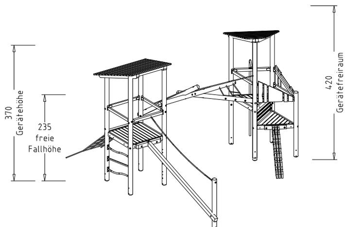
Beschreibung: 8 Steher, 1 Viereckpodest, 2 Dreieckpodeste, 8 Handläufe, 2 Pultdächer aus profilierter Schalung, 1 Netzeinstieg ohne Rahmen, 1 Sprossen-Aufstieg Edelstahl, 1 Balancierbalken-Aufstieg mit Handlaufseil, 1 Stangen-Kletter-Übergang 3 m, 1 Feuerwehr-Kletterstange, 1 Stufenbaum, 1 Zwischenleiter.
