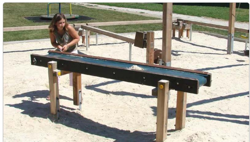
Beschreibung: 4 Steher (Pfosten), aus Kanthölzern 9/9 cm, 2 Unterzüge, aus Kanthölzern 7/7 cm, 2 Seitenwangen aus Siebdruckplatte, 2 Stahl-Wellen Ø 20 mm, kugelgelagert, 2 Laufwalzen Ø ca. 100 mm, 1 Welle mit Handrad, 1 Welle mit Spannvorrichtung, 1 Gewebeband, 2 schräge Lippen oben zur Abdeckung der Konstruktion.
