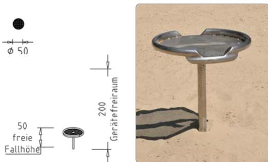
Beschreibung: Konstruktion komplett in Edelstahl, geschweißt, Standrohr Ø ca. 45 mm, drehbares Sieb aus Lochblech, Gleitlager.
