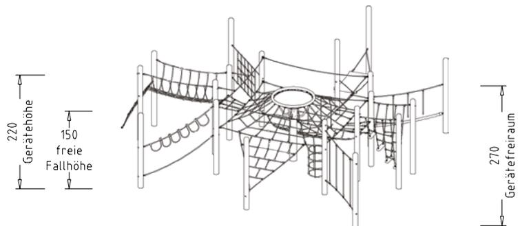
Beschreibung: 19 Steher (Pfosten), Rundhölzer Ø 14 cm, 1 Adlerhorst, auf Rundholzsteher Ø 20 cm aufgesetzt, 1 Pyramidennetz, vom Adlerhorst zu den Viereckstehern abgespannt, 1 Dreiecknetz, schräg abgespannt, insgesamt 8 Balancier- und Kletter-Varianten, 1 Hängematte, 1 Kletterkamin. Aufständering mit 20 Stk. Vierfachlaschen.
