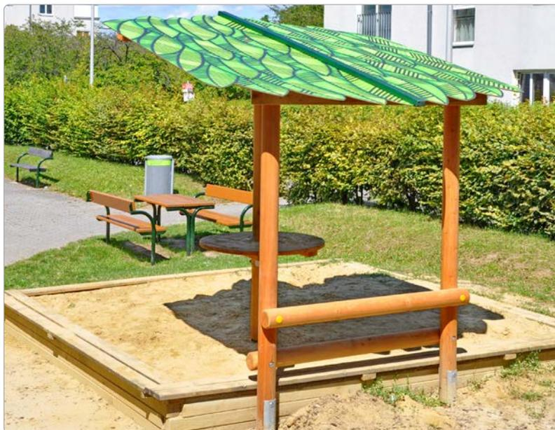
**Beschreibung:** 2 Steher (Pfosten), aus Rundhölzern Ø 12 cm, 1 Steher Ø 16 cm, 2 Sitzhölzer Ø 12 cm geblattet, 1 Tisch aus Kanthölzern Ø 100 cm, mit Stahlwinkeln an Steher befestigt, 1 Pultdach in 2 Segmenten, aus HPL-Platte, Unterkonstruktion mit Kanthölzern 7/13 cm, 8 Hocker aus Rundhölzern Ø ca. 25 cm, mit Kern.
