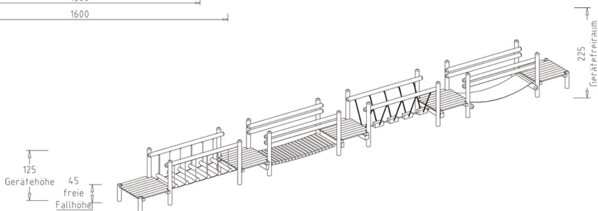
Beschreibung: 5 Podeste aus je 4 Steher (Pfosten) Ø 10 cm, 2 Unterzüge aus Kant-hölzern (KH) 7/7 cm, Belag aus KH 2,5/10 cm, genietet, 1 Kettenbrücke, aus Rund-hölzern Ø 10 cm, 1 Wackelbrücke mit Spannvorrichtung, 1 Balancierklotzbrücke, Balancierklötze aus KH 11/11 cm, Kettenabhängungen und Längsketten Ø 6 mm, 1 Gummibahnbrücke, alle längs laufenden Hölzer Ø 10 cm.
