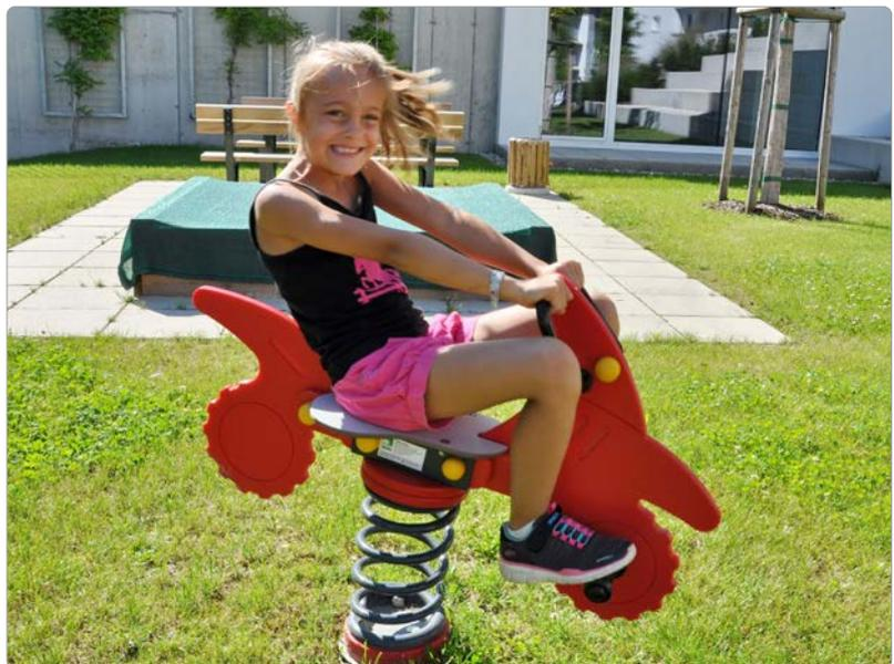
**Beschreibung:** Konturgefärbte HDPE-Platten 19 mm, färbig, 1 Sitz aus HPL-Platte 10 mm, grau, mit strukturierter, rutschhemmender Oberfläche, 2 Haltegriffe, 2 Fußrasten aus Polyamid, 1 Feder Ø 17 cm mit 2 Federtellern, anthrazitgrau pulverbeschichtet.
