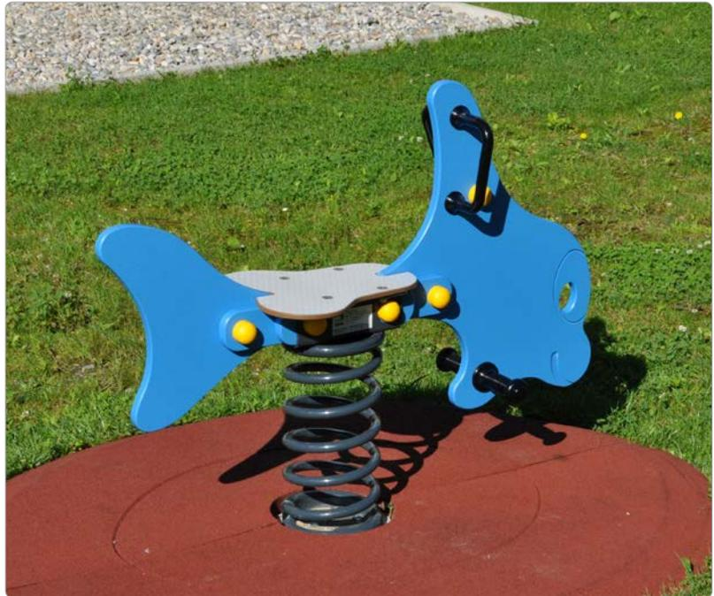
**Beschreibung:** Konturgefärbte HDPE-Platten 19 mm, färbig, 1 Sitz aus HPL-Platte 10 mm, grau, mit strukturierter, rutschhemmender Oberfläche, 2 Haltegriffe, 2 Fußrasten aus Polyamid, 1 Feder Ø 17 cm mit 2 Federtellern, anthrazitgrau pulverbeschichtet.
