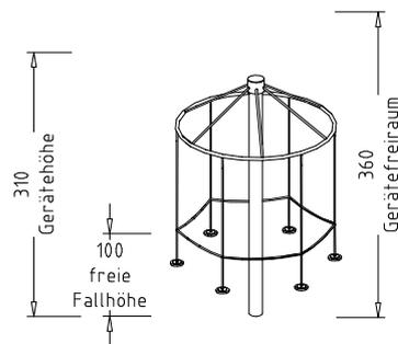
Beschreibung: 1 Rundrohr  $\varnothing$  153/6 mm, 1 Bodenhülse mit Schraubsicherung, feuerverzinkt, 1 Stahlrohrring, sternförmig an Gleitscheibe aufgehängt, 6 Kettenabhängungen, 6 Pendelsitze, mit Ketten-Querverbindungen, um ein unkontrolliertes Auspendeln der Sitze zu verhindern.
