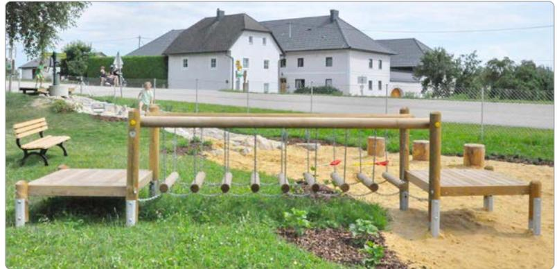
**INFO!** Die maximale freie Fallhöhe ab Oberkante Wackelhölzer darf 2 m nicht überschreiten!
