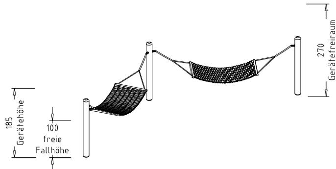
Beschreibung: Hängematten aus Stahlseilnetz oder Gummigliederplatte, 3 Stk. Steher aus Rundhölzern od. Stahlrohren, mittels Kreuzgelenken befestigt.
