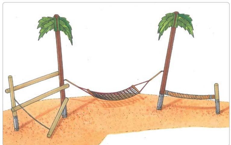
2 Steher (Pfosten), aus Rundhölzer (RH) Ø 16 cm, kastanienfarben lasiert, 2 Steher, aus RH Ø 14 cm, 3 Sitz- bzw. Kletterhölzer, aus RH Ø 14 cm, 1 Herkules-Halteseil, 1 Tau aus Polypropylen, mit Stahleinlage, Ø 15 cm, 8 Palmenblätter aus HPL-Platte, mit aufkaschierten Design-Folien, mit Schutzlaminat versehen, 1 Hängematte aus Herkulestau, an 2 Kreuzgelenken durch Steher Ø 16 cm durchgeschraubt.
