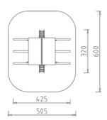
Beschreibung: Sparren aus Kanthölzer 9/11 cm kerngetrennt (kernfrei), Querhölzer 9/9 cm, Bodenbelag 4/11cm, Dach und Fronten aus Siebdruckplatten 20 mm, 2 Strickleiter-Aufstiege, 4 Haltegriffe, 1 Netz aus Stahlseil, kunststoffummantelt Ø 16 mm, 6 Befestigungspunkte.
