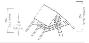
76311 Dach mit Liegenetz 76312 Dach mit Liegenetz, ohne Kletterelemente
