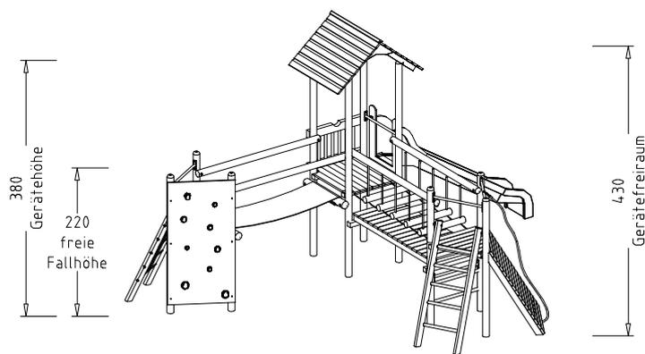
Beschreibung: 2 Turmteile mit Sprossenwand senkrecht, 1 Turmteil mit Brüstungselement, 4 Steher (Pfosten), 1 Viereckpodest, 2 Dreieckpodeste, 1 Leiter, 1 Netzeinstieg, 1 schiefe Ebene mit Hangeltau, 1 Kettenbrücke, 1 Gummibahnbrücke, 1 Bergsteiger-Kletterwand senkrecht, 4 Handläufe, 1 Giebeldach.
